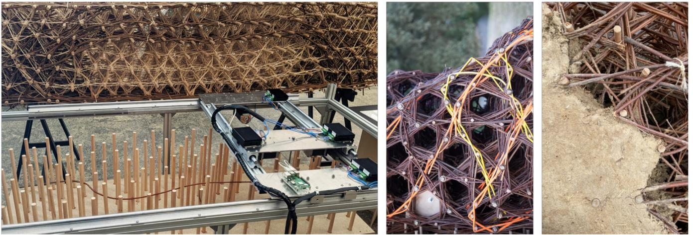
Der am KIT entwickelte Roboter (links) spleißt die Weidenruten zu einem Endlosstrang zusammen und erstellt ein Bauteil mit Korbstruktur (Mitte). Zur Erhöhung der Stabilität werden die Zwischenräume mit Lehm ausgefüllt (rechts).
