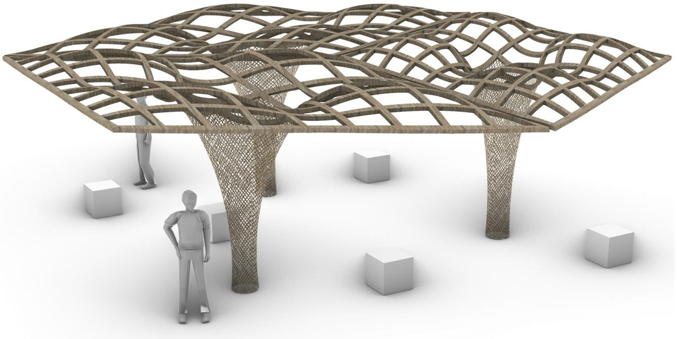
Entwurf des Demonstrationsbaus mit Stützpfeilern aus Flachsfasern und einer Dachkonstruktion aus Holz für die BUGA 2023 in Mannheim.
