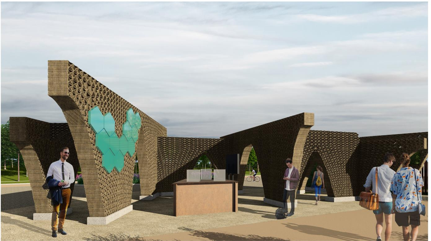
Entwurf des Demonstrationsbaus aus Weiden-Lehm-Komposit mit integrierten Solarpaneelen (grün) für die BUGA 2023 in Mannheim.
